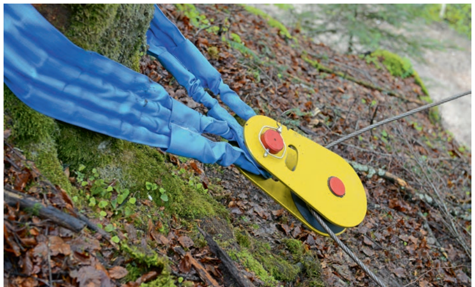
Die Umlenkrolle «LT-Gelb» ist für Forstwinden von über 8 t Zugkraft vorgesehen und weist eine Bruchlast von 28 t auf.
